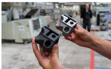
HEIDELBERG utiliza piezas impresas en 3D se utilizan para una amplia gama de aplicaciones, que incluyen piezas ligeras para robots y piezas de recambio para componentes de máquinas que antes se fabricaban con acero.
