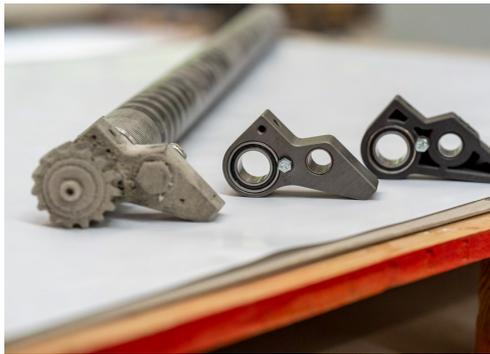
Las piezas de recambio impresas en 3D se ensamblan con rodamientos y componentes metálicos antifricción.
