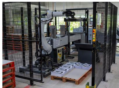
La P-Stacker se ocupa de la ardua tarea de apilar paquetes detrás de la máquina de plegado, reduciendo la carga de trabajo de los operarios.
