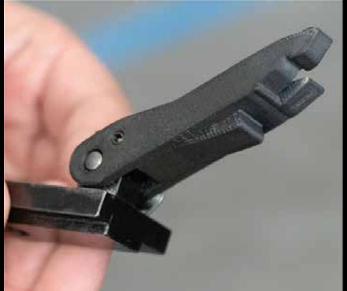
Muchas de las piezas de las máquinas pueden ser fácilmente reemplazadas en Vogel Druck. Por ejemplo, es común que un "dedo" de una máquina se quiebre, lo cual su costo podría ser de aproximadamente €450 para reemplazo. La impresión de un dedo cuesta solamente €3.50. Con alrededor de 30 a 40 reemplazos de dedos requeridos por año, cerca de €20,000 fueron ahorrados en un relativamente corto espacio de tiempo.
