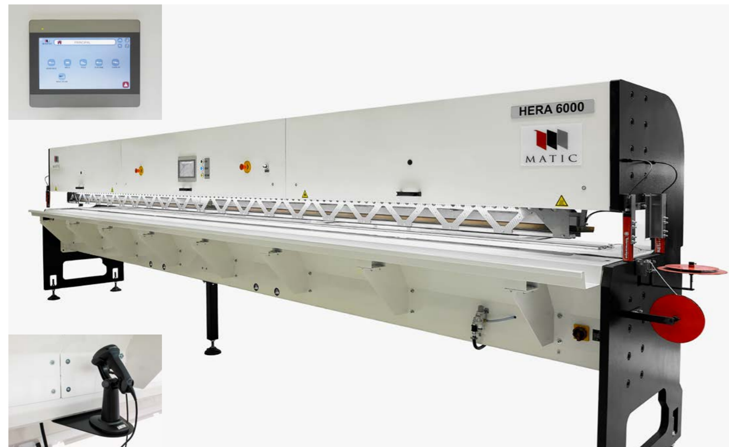
HERA welder, Touchscreen operation, QR code reader Modelo Hera, control por pantalla táctil, lector Código QR
